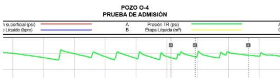
Figura 12. Cédula y gráfico de admisión con solvente base hidrocarburo, salmuera gelificada y diésel.
