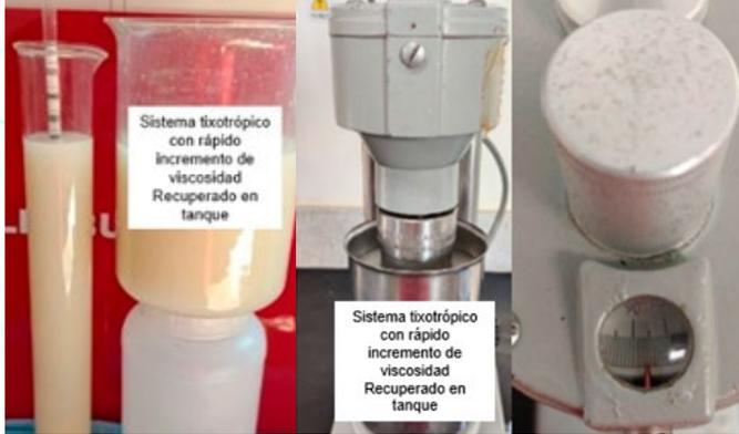
Figura 11. Medición reológica y densidad de los sistemas a bombear.
