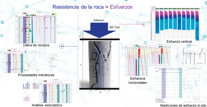
Figura 7. Metodología de caracterización geomecánica aplicada al almacenamiento de hidrocarburos en cavernas.
