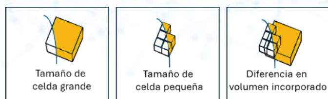
Figura 5. Representación gráfica del impacto que tiene el considerar celdas de mayor tamaño respecto a los elementos a incluir en la malla.
