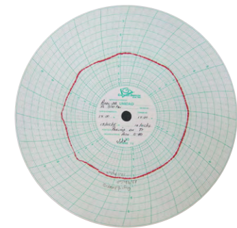
Figura 10. En este pozo se aumentó gradualmente la inyección de gas de Bombeo Neumático de 2.9 hasta 4.3 MMPCD en 3 días.
