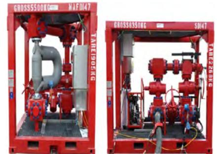
Figura 3.3 Estrangulador automatizado y medidor de flujo
