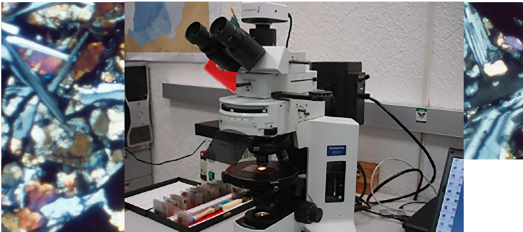
Figura 2. Microscopio petrográfico de luz transmitida y fluorescencia UV.
