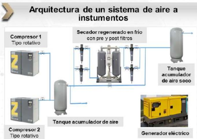
Figura 6. Diagrama del sistema de aire a instrumentos instrumentospilotos y purga
